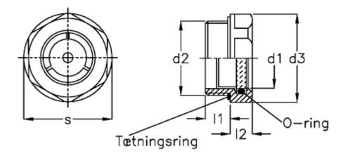
d1 = 24 d2 = M33x1,5 d3 = 40 l1 = 11.0 l2 = 8.5 Max pressure = -Max vacuum mbar = s = 36
